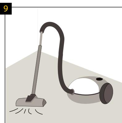
Ujistěte se, že podklad je suchý, rovný, stabilní a bez mastnoty nebo chemikálií. Odstraňte nebo vyhladte vyčnívající nerovnosti. Před instalací pečlivě zameňte a vysaje podklad, aby ste odstranili veškeré znečištění. Případné vážnější vadu základů a velké trhliny je nutné opravit.
