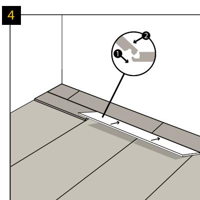
Podlahové panely Afirmax jsou vybaveny spojovacími zámkami na dlouhé i krátké straně. Nejprve spojte panel dlouhou stranou a za tímto účelem zasuňte dlouhou stranu panelu do drážky dříve namontovaného panelu. Posuňte jej k rohu a ponechejte nevelkou vůli.
