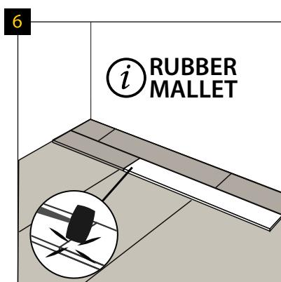
Použijte pogumované kladivo. Poznámka! Každý panel obsahuje pouze 1 zámek, který může být připnutý. Je nutné nainstalovat další zámkы bez zajištění (viz montáž, obrázek 4). Poznámka! Předtím zámek velmi pečlivě vyzkoušejte zajištění (chybějící přesné usazení zámků a pak zajetí panelu způsobí jeho poškození, které bude mít za následek zamítnutí případná reklamace).
