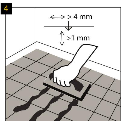
V případě instalace na keramický obkladový podklad, švy se spárami širšími než 4 mm a hlubšími než 1 mm zalijte trvanlivou spárovací hmotou, jako je pryžová spárovací hmota. Schváleno pro instalaci na dlaždice se spárovací hmotou neširší než 5 mm a nehlubší než 1 mm bez použití stérkové hmoty při použití jako podklad „Multiprotec Super Hardlay“ nebo „Vinclic Super Solid“.
