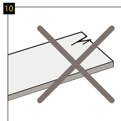
Před a během montáže kontrolujte panely za optimálních světelných podmínek. Nepoužívejte vadné panely.
