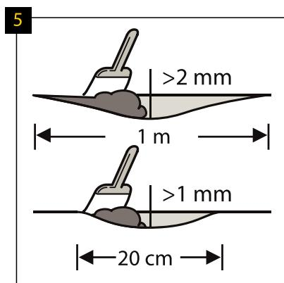
Ujistěte se, že základna je zcela rovná. Všechny nerovnosti podkladu přesahující 1 mm a přesahující 20 cm na délku nebo přesahující 2 mm a přesahující 1 m na délku musí být vyrovnány. Zkontrolujte, zda je třeba použít základní nátěr nebo izolační materiál. Pro přípravu dokonalého podkladu naneste na celý povrch cementovou maltu nebo samonivelační hmotu.
