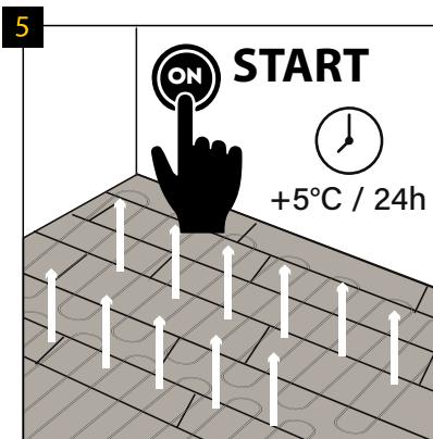
Po 24 hodinách od položení podlahy můžete zapnout její vytápění. Nezapomeňte teplotu zvyšovat postupně (o 5 °C za den).
