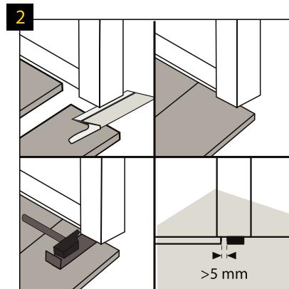
Dilatační spáry podél stěn musí být uzavřeny dekorativní lištou, připevněnou lepidlem nebo speciálními sponami. Doporučuje se použít dekorativní lišty Arbiton určené pro tento panel, které zaručí vynikající barevnou shodu a odolnost proti poškrábání.
