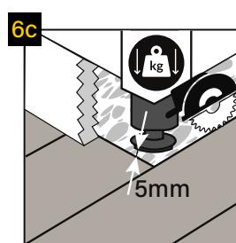
V případě umístění těžkých předmětů na podlaze (např. kuchyňský nábytek, kuchyňský ostruvek, vestavěně skříně a další nábytek připevněný ke stěně) je třeba mezi nimi ponechat 5 mm dilatační spáry. Pro ponechání dilatačních spár doporučujeme následující metody:
