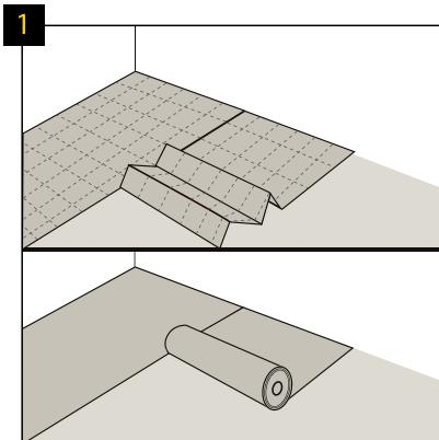
Podklad "Arbiton", "Ewifoam" nebo "Afirmax" položte kolmo ke směru pokládky panelů. Sousední řady podkladové podložky by k sobě měly těsně přiléhat a měly by být spojeny překrytím nebo páskou Arbiton AluTape bez jakékoli mezery.
