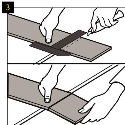
Pro dodatečné řezání podlahových panelů ostrým nožem odřízněte horní vrstvu a rychle odlomte část panelu položeného na okraj. Podlahové panely lze navíc snadno řezat elektrickou pilou.
