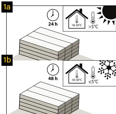
Pokud je teplota během přepravy  $>5^{\circ}\text{C}$ , doba aklimatizace v místnosti s a teplota  $18-30^{\circ}\text{C}$  by měla být min. 24 hodin (v prostorách, kde budou být nainstalován). Ovšem v případě teploty  $\leq 5^{\circ}\text{C}$  během přepravy, doba aklimatizace v místnosti s teplotou  $18-30^{\circ}\text{C}$  by měla být min. 48 hodin.
