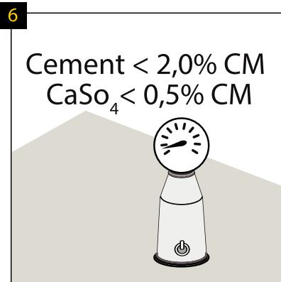
V případě cementového základu musí být obsah vlhkosti v něm nižší než 2,0% a v případě anhydritu - nižší než 0,5%. V případě instalace s podlahovým vytápěním by výše uvedené hodnoty mely být 1,8 % a 0,3 %.
