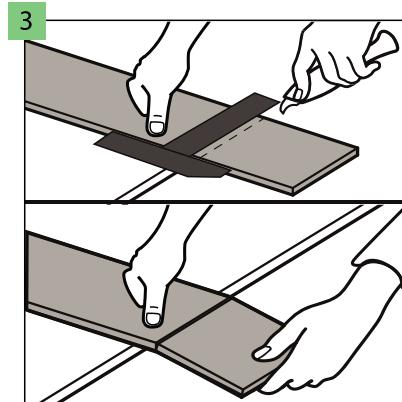
Za dodatno rezanje podnih ploča, oštrom nožem odrežite gornji sloj i brzo odlomite dio ploče, i položite ga na kraj. Osim toga, podne ploče se lako režu električnom tpihom.
