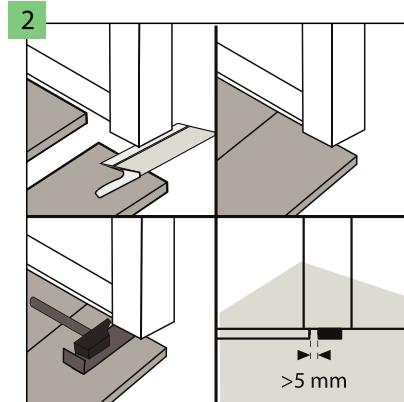
Kompenzacijske zazore duž zidova treba zatvoriti ukrasnom letvicom, pričvršćenom ljepilom ili posebnim stezaljkama. Preporuča se koristiti Arbiton ukrasne letvice namijenjene za navedene ploče, koje jamče izvrsno podudaranje boja i otpornost na ogrebotine.
