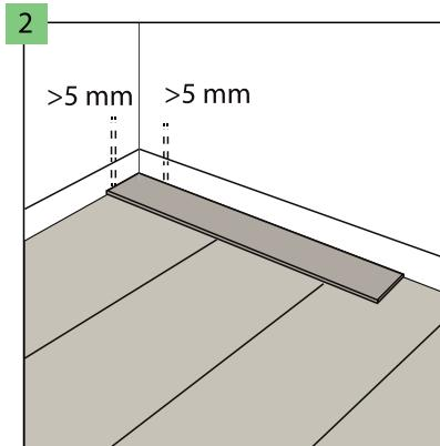
Ostavite razmake od 5 mm po obodu u odnosu na zidove, kako biste kompenzirali linearno širenje poda. Maksimalna površina koja se može postaviti bez dodatnih razmaka je 200 m<sup>2</sup>. Za veće površine treba povećati sve razmake na 10 mm. Maksimalna duljina podne površine u jednom smjeru, koja se može polagati bez dodatnih dilatacijskih razmaka, je 20 m. Za veće duljine, povećajte sve razmake na 10 mm.
