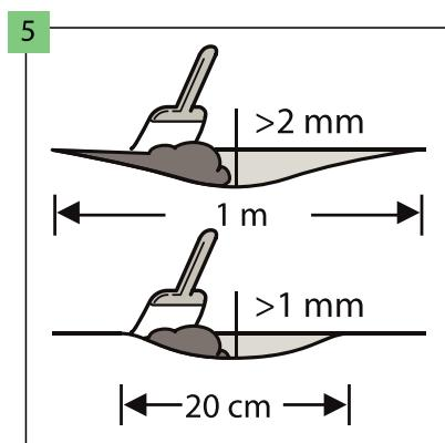
Provjerite je li podloga potpuno ravna. Sve neravnine na podlozi veće od 1 mm i dulje od 20 cm u duljinu, odnosno veće od 2 mm i dulje od 1 m, moraju se izravnati. Provjerite treba li koristiti temeljni premaz ili izolacijski materijal. Za pripremu savršene podlage nanesite cementni mort ili samoizravnjavajuću masu na cijelu površinu.
