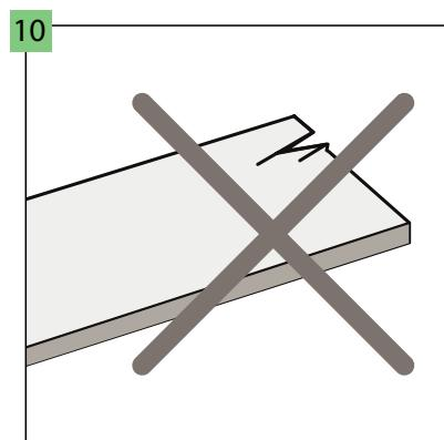
Prije i tijekom polaganja poda, kontrolirajte ploče pod optimalnim uvjetima osvjetljenja. Nemojte koristiti neispravne ploče.
