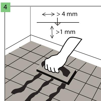
U slučaju ugradnje na podlogu od keramičkih pločica, fuge s razmacima širim od 4 mm i dubljim od 1 mm popunite dugotrajnom masom za fugiranje kao što je gumena fug masa. Dopuštena je ugradnja na pločice sa fugama ne širim od 5 mm i ne dubljim od 1 mm bez upotrebe mase za izravnavanje kada se kao podloga koristi "Multiprotec Hardlay" ili "Vinclic Solid".
