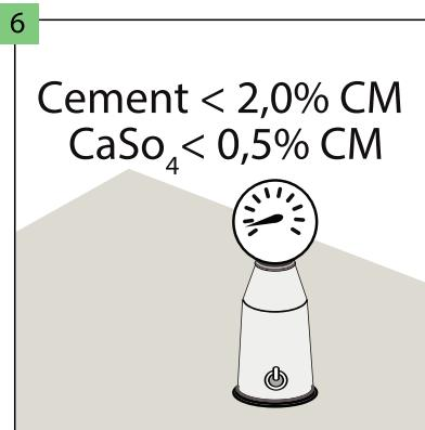
U slučaju cementne podloge, sadržaj vlage u njoj mora biti ispod 2,0%, a u slučaju anhidrita - ispod 0,5%. U slučaju polaganja poda na sustav podnog grijanja, gornje vrijednosti trebaju biti 1,5% odnosno 0,3%.
