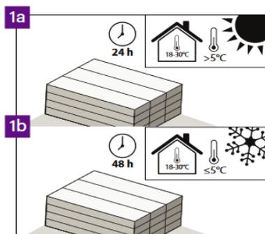
Per temperature  $>5^{\circ}\text{C}$  durante il trasporto, il tempo di acclimatazione in una stanza con una temperatura di 18-30°C dovrebbe essere di 24 ore (nella stanza in cui verranno installati i pannelli). Per temperature  $\leq 5^{\circ}\text{C}$  durante il trasporto, il tempo di acclimatazione in una stanza con una temperatura di 18-30°C dovrebbe essere di 48 ore.
