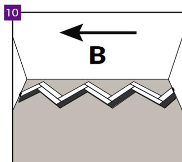
È importante che il montaggio di ogni fila sia eseguito in conformità al principio secondo cui i pannelli B vengono montati verso sinistra, cioè in senso opposto a quello di montaggio dei pannelli A.
