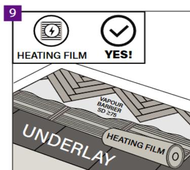
È consentita anche l'installazione su film riscaldante, a condizione che si utilizzi una base adeguata sotto il film riscaldante e un film di barriera al vapore SD  $\geq 75$  sul film riscaldante. L'intero sistema è costituito da un film di barriera al vapore posato direttamente sul substrato, seguito da una base adeguata (min. 400 kPa, spessore consigliato della base è di 5 mm), dal film riscaldante, dal film barriera al vapore e dal pavimento.
