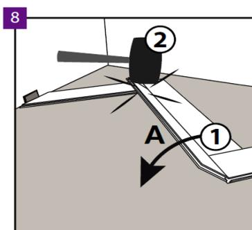
Anche la posa della seconda fila deve essere iniziata con il pannello A. Si prega di ricordare sempre le regole di posa dei pannelli – durante l'installazione del pannello B sul pannello A, i lati lunghi sono montati tramite bloccaggio, mentre i lati corti sono montati tramite infissione.
