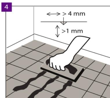
Nel caso di installazione sul substrato rivestito con piastrelle in ceramica, riempire i giunti delle piastrelle con uno spazio più largo di 4 mm e più profondo di 1 mm con un composto resistente per il riempimento di punti, ad esempio malta di resina. L'installazione è consentita su piastrelle con fughe non più larghe di 5 mm e 1 mm di profondità senza l'utilizzo di un composto livellante, a condizione che ci sia il sottopavimento Multiprotec Super Hardlay o Vinclic Super Solid.
