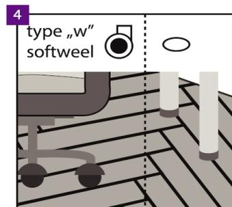
Utilizzare sedie da ufficio con ruote tipo W, proteggendo ulteriormente il pavimento con la rete di protezione. Le gambe del mobile devono essere provviste di imbottiture protettive che proteggono dai graffi, ad esempio in feltro.
