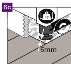
Nel caso di oggetti pesanti collocati sul pavimento (come mobili da cucina, isole da cucina, armadi a muro e altri mobili fissati in modo permanente alla parete), è necessario lasciare attorno ad essi i giunti di dilatazione di 5 mm. Per preservare gli spazi dei giunti di dilatazione consigliamo i seguenti metodi:
