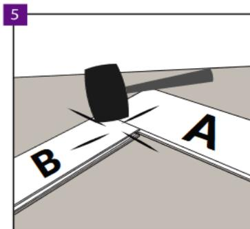
Poi posizionare il pannello A. Poi unire il pannello B con il pannello A usando un martello gommato.
