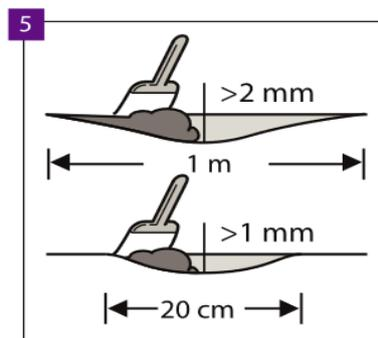
Assicurarsi che il substrato sia completamente piatto. Tutte le irregolarità del substrato superiori a 1 mm, con una lunghezza superiore a 20 cm o superiori a 2 mm, con una lunghezza superiore a 1 m devono essere livellate. Controllare se è necessario l'uso del materiale di priming o sigillante. Per preparare perfettamente il substrato, distribuire la malta o il composto autolivellante su tutta la superficie.
