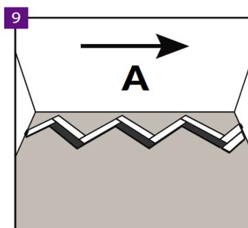
È molto importante che l'installazione di ogni fila sia eseguita secondo il principio di installazione dei pannelli A verso destra.
