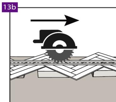
Quando si esegue il taglio, si raccomanda di usare distanziatori che devono essere posizionati sotto il pavimento per evitare danni al sottopavimento. L'altezza dei distanziatori va regolata in conformità alle istruzioni fornite dal produttore della sega circolare o della sega con guida.
