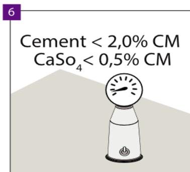
Nel caso del substrato in cemento, il contenuto di umidità nel substrato deve essere inferiore al 2,0% e, nel caso del substrato in anidrite, deve essere inferiore allo 0,5%. Nel caso di installazione dell'impianto di riscaldamento a pavimento, i valori sopra indicati devono essere rispettivamente dell'1,8% e dello 0,3%.
