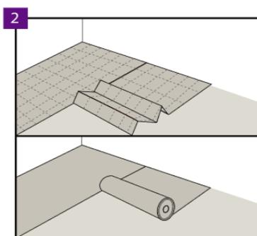
Assicurarsi che il substrato sia stato preparato correttamente. Posare il sottopavimento del marchio Arbiton o Ewifoam destinato alla posa di pavimenti rigidi e di pavimenti LVT. I lati di sottopavimento devono essere aderenti e uniti mediante overlap o nastro Arbiton o Ewifoam AluTape, senza lasciare spazio ridondante.
