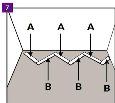
La prima fila deve essere costituita dai pannelli disposti alternatamente, che saranno montati esattamente come mostrato nella figura riportata.
