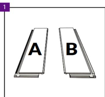
Ogni confezione contiene due tipi di pannelli: A e B. I singoli pannelli sono contrassegnati in fondo come A o B per facilitare la distinzione. Le parti A e B devono essere selezionate separatamente prima dell'installazione. Durante l'installazione è molto importante garantire che i pannelli A e B siano posati nei punti giusti della fila (vedi -> Installazione dei pannelli, punti 7; 9 e 10).
