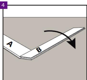
Montare (bloccare) il pannello B, senza usare un martello, spingendolo nel senso indicato nella figura sopra.
