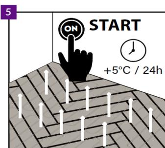
Dopo aver posato il pavimento e aver atteso 24 ore, è possibile accendere il riscaldamento a pavimento. Ricordate di aumentare la temperatura gradualmente (5°C al giorno).
