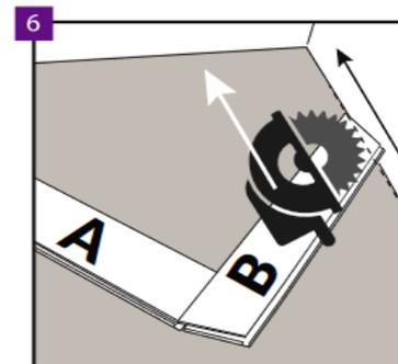
Installare il successivo pannello B nella stessa fila (vedi Manuale di posa del pavimento – Fig. 4).
