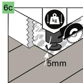
Nel caso di oggetti pesanti collocati sul pavimento (come mobili da cucina, isole da cucina, armadi a muro e altri mobili fissati in modo permanente alla parete), è necessario lasciare attorno ad essi i giunti di dilatazione di 5 mm. Per preservare gli spazi dei giunti di dilatazione consigliamo i seguenti metodi:
