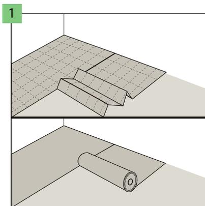
Posare il sottopavimento Arbiton, Ewifoam o Afirmax perpendicolarmente alla direzione di posa dei pannelli. I nastri adiacenti del sottopavimento devono essere ben aderenti e uniti mediante overlap o nastro Arbiton AluTape, senza lasciare spazio ridondante.
