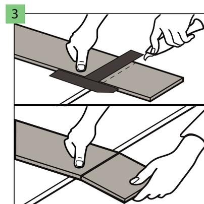
Per tagliare ulteriormente i pannelli del pavimento, utilizzare un coltello affilato per tagliare lo strato superiore, poi rompere il pannello in modo dinamico appoggiandolo sul bordo. I pannelli del pavimento possono essere tagliati facilmente anche con una sega elettrica.
