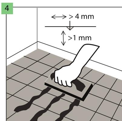
Nel caso di installazione sul substrato rivestito con piastrelle in ceramica, riempire i giunti delle piastrelle con uno spazio più largo di 4 mm e più profondo di 1 mm con un composto resistente per il riempimento di punti, ad esempio malta di resina. L'installazione è consentita su piastrelle con fughe non più larghe di 5 mm e 1 mm di profondità senza l'utilizzo di un composto livellante, a condizione che ci sia il sottopavimento Multiprotec Hardlay o Vinclic Solid.
