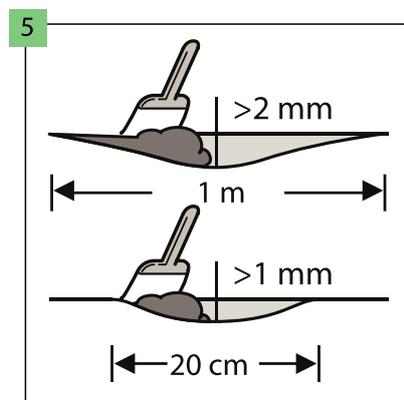
Assicurarsi che il substrato sia completamente piatto. Tutte le irregolarità del substrato superiori a 1 mm, con una lunghezza superiore a 20 cm o superiori a 2 mm, con una lunghezza superiore a 1 m devono essere livellate. Controllare se è necessario l'uso del materiale di priming o sigillante. Per preparare perfettamente il substrato, distribuire la malta o il composto autolivellante su tutta la superficie.
