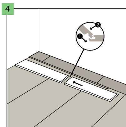
I pannelli del pavimento sono dotati di incastri sul lato corto e sul lato lungo. Per prima cosa incastrare i lati corti dei pannelli adiacenti.
