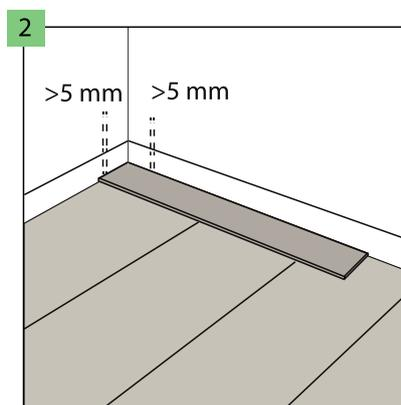
Lasciare 5 mm di spazio perimetrale alle pareti per consentire l'espansione del pavimento. La superficie massima che può essere posata senza giunti di dilatazione aggiuntivi, è di 200 m<sup>2</sup>. Oltre questa superficie, allargare tutti i giunti di dilatazione fino a 10 mm. La lunghezza massima della superficie del pavimento in una direzione, che può essere posata senza giunti di dilatazione aggiuntivi, è di 20 m. Oltre questa lunghezza, allargare tutti i giunti di dilatazione fino a 10 mm.
