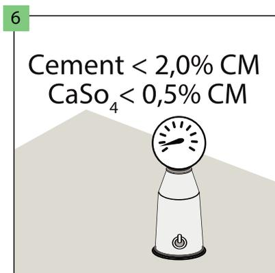
Nel caso del substrato in cemento, il contenuto di umidità nel substrato deve essere inferiore al 2,0% e, nel caso del substrato in anidrite, deve essere inferiore allo 0,5%. Nel caso di installazione dell'impianto di riscaldamento a pavimento, i valori sopra indicati devono essere rispettivamente dell'1,5% e dello 0,3%.
