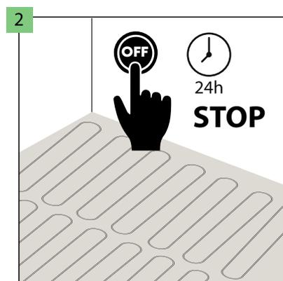
Prima della loro installazione i pannelli devono essere sottoposti all'acclimatazione 24 ore alla temperatura di 18-30°C nei locali in cui verranno installati. In caso di trasporto e/o conservazione a temperature inferiori a +5°C, il tempo di acclimatazione deve essere prolungato fino a 48 ore.
