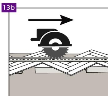
Lors de la coupe, il est recommandé d'utiliser des pinces qui doivent être installées sous le sol pour éviter d'endommager le substrat. La hauteur des fixations doit être ajustée conformément aux instructions du Fabricant de la scie circulaire ou de la scie à guidage.
