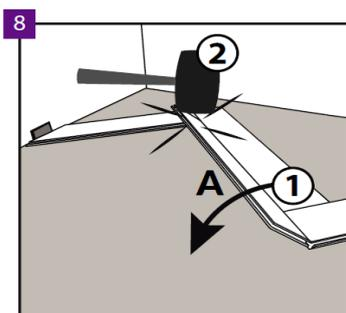
La pose de la deuxième rangée doit également commencer par le panneau A. S'il vous plaît, veuillez toujours garder à l'esprit les règles d'installation des panneaux - lors de l'installation du panneau B sur le panneau A, les côtés longs sont installés par fixation et les côtés courts sont installés par enfoncement.
