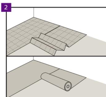
ARBITON d'origine. Assurez-vous que la base est correctement préparée. Ensuite, posez la sous-couche de la marque Arbiton ou Ewifoam, qui est destinée à la pose de sols durs et LVT. Les bandes de sous-couche adjacentes doivent être bien ajustées et jointes en chevauchement ou avec du ruban Arbiton ou Ewifoam AluTape, sans laisser d'espace entre elles.
