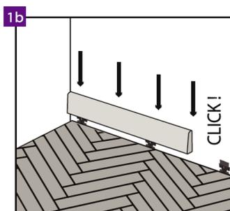
Couvrir les dilatations le long des murs avec des plinthes décoratives, en les collant ou en les fixant à l'aide de clips spéciaux. Il est recommandé d'utiliser des plinthes de la marque Arbiton dédiées à un modèle donné de lame de parquet, ce qui garantit une excellente harmonie des couleurs et un revêtement résistant aux rayures.
