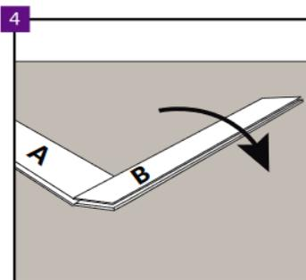
Installer ( fixer ) sans utiliser de marteau le panneau B va vers l'intérieur dans le sens indiqué sur la figure ci-dessus.
