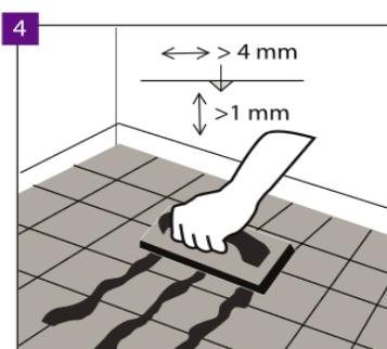
En cas d'installation sur une base carrelée en céramique, jointoyez les joints avec des espaces plus larges que 4 mm et plus profonds que 1 mm avec un composé à joints durable tel qu'un coulis en caoutchouc. Approuvé pour l'installation sur des carreaux avec un joint d'au plus 5 mm de large et d'au plus 1 mm de profondeur sans l'utilisation d'un composé de nivellement lorsqu'il est utilisé comme support "Multiprotect Super Hardlay" ou "Vinclic Super Solid".
