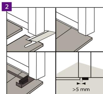
Pour les portes, il est conseillé de découper les profilés du cadre et de laisser un espace libre au-dessus de la lame de parquet posée, afin de ne pas entraver les possibilités de mouvement.
