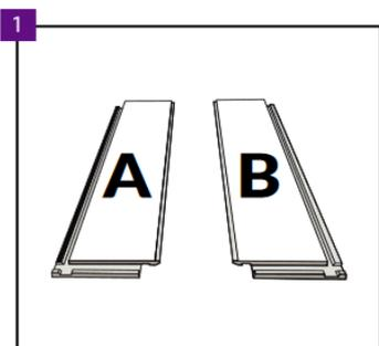
Chaque emballage contient deux types de panneaux: A et B. Les unités de panneaux sont étiquetées en bas comme A ou B pour faciliter la différenciation. Les pièces A et B doivent être triées séparément avant l'installation. Lors de l'installation, il est très important de s'assurer que les panneaux A et B sont installés aux endroits appropriés de la rangée ( voir -> pose des panneaux, points 7; 9 et 10).
