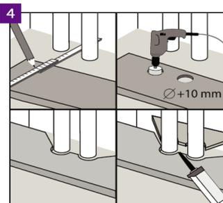
Procédez de la même manière pour plus de tuyaux dans le système de chauffage. Les éléments de panneau découpés doivent être reliés à l'aide d'un adhésif de montage pour éléments en plastique.
