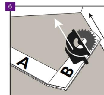
Installez le panneau B suivant dans la même rangée ( voir le Guide d'installation au sol - Fig. 4). Coupez le panneau en vous assurant d'utiliser les espaces de dilatation appropriés contre les murs ( voir le guide de pose de plancher - Fig. 15 ).
