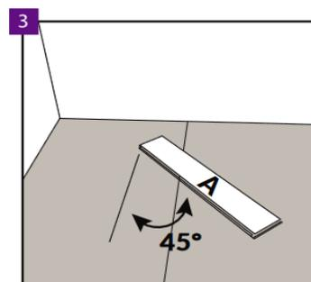
Commencez l'installation de gauche à droite avec le panneau A, qui doit être tourné de 45°. Les bords des panneaux le long du mur doivent être coupés à la taille à un angle de 45° proportionnel aux murs. ATTENTION! Veillez à conserver les espaces de compensation appropriés aux murs (voir installation, figure 15).
