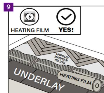
La pose sur un film chauffant est également possible à condition qu'une sous-couche appropriée soit utilisée sous le film chauffant et qu'un film pare-vapeur SD  $\geq 75$  soit utilisé sur le film chauffant. L'ensemble du système se compose d'un film pare-vapeur posé directement sur le sol, suivi d'une sous-couche appropriée (min. 400 kPa, épaisseur recommandée de la sous-couche : 5 mm), d'un film chauffant, d'un film pare-vapeur et du revêtement de sol.
