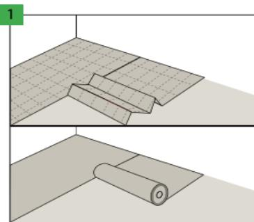
Podklad "Arbiton", "Ewifoam" nebo "Afimax" položte kolmo ke směru pokládky panelů. Sousední řady podkladové podložky by k sobě měly těsně přiléhat a měly by být spojeny překrytím nebo páskou Arbiton AluTape bez jakékoli mezery.
