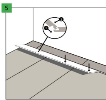
Poté připevněte spojenou řadu k dříve položeným řadám dlouhou stranou. POZNÁMKA! Pro zkušené montéry se doporučuje druhý způsob spojování panelů: montuje každý další panel postupným spojováním s dříve nainstalovaným panelem. Chcete-li to provést, nejprve upevněte zámek panelu na jeho krátké straně, spusťte panel podél dlouhé strany, ponechte úzkou mezitu, a poté panel mírně zvedněte pod úhlem 20-25°, abyste zajistili zámek na dlouhé straně. Opakujte tyto kroky pro další panel.
