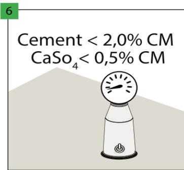
V případě cementového základu musí být obsah vlhkosti v něm nižší než 2,0% a v případě anhydritu - nižší než 0,5%. V případě instalace s podlahovým vytápěním by výše uvedené hodnoty měly být 1,8% a 0,3 %.
