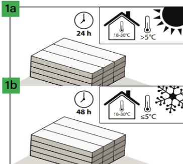
Pokud bude během dopravy teplota  $>5^{\circ}\text{C}$ , bude aklimatizace při teplotě 18–30 °C trvat 24 hodin (v místnosti, kde proběhne pokládka). Pokud bude během dopravy teplota  $\leq 5^{\circ}\text{C}$ , bude aklimatizace při teplotě 18–30 °C trvat 48 hodin.
