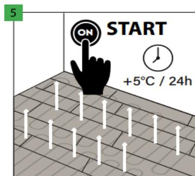
Po 24 hodinách od položení podlahy můžete zapnout její vytápění. Nezapomeňte teplotu zvyšovat postupně (o 5 °C za den).
