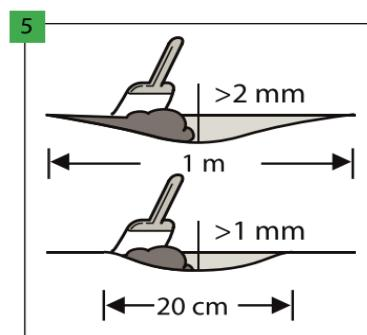
V případě instalace na keramický obkladový podklad, švy se spárami širšími než 4 mm a hlubšími než 1 mm zalijte trvanlivou spárovací hmotou, jako je pryžová spárovací hmota. Schváleno pro instalaci na dlaždice se spárovací hmotou ne širší než 5 mm a ne hlubší než 1 mm bez použití stěrkové hmoty při použití jako podklad „Multiprotec Hardlay“ nebo „Vinclic Solid“. V případě pokládky na povrch pokrytý keramickým obkladem vyplňte spáru obkladů a napenetrujte celý povrch.
