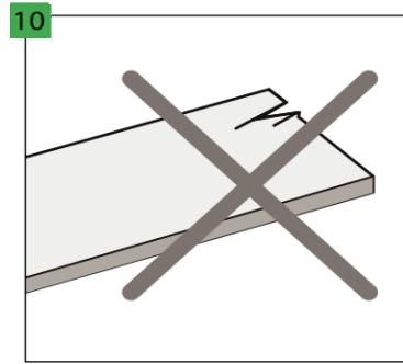
Před a během montáže kontrolujte panely za optimálních světelných podmínek. Nepoužívejte vadné panely.
