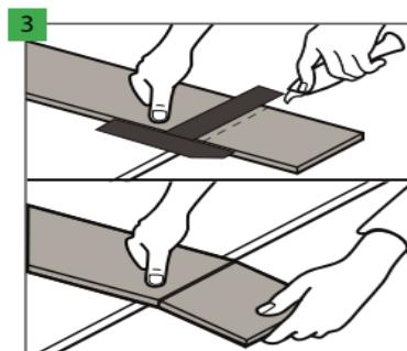
Pro dodatečné řezání podlahových panelů ostrým nožem odřízněte horní vrstvu a rychle odlomte část panelu položeného na okraj. Podlahové panely lze navíc snadno řezat elektrickou pilou.
