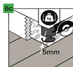
V případě umístění těžkých předmětů na podlaze (např. kuchyňský nábytek, kuchyňský ostrůvek, vestavěné skříně a další nábytek připevněný ke stěně) je třeba mezi nimi ponechat 5 mm dilatační spáry. Pro ponechání dilatačních spár doporučujeme následující metody:
