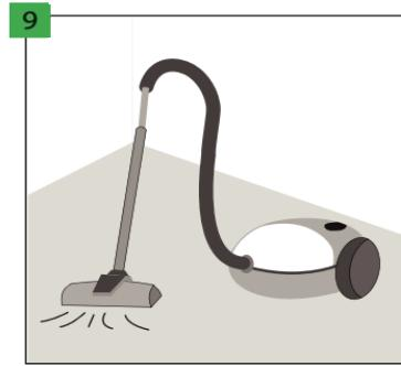
Ujistěte se, že podklad je suchý, rovný, stabilní a bez mastnoty nebo chemikálií. Odstraňte nebo vyhladte vyčívající nerovnosti. Před instalací pečlivě zameďte a vysajte podklad, abyste odstranili veškeré znečištění. Případné vážnější vadu základů a velké trhliny je nutné opravit.
